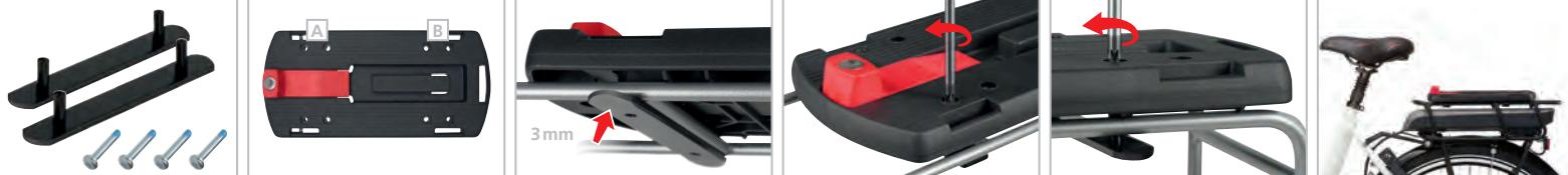
**Montage** Der Adapter lässt sich auf üblichen Gepäckträgern bis 145mm Breite montieren. Adapter mit der roten Taste nach vorn auf den Gepäckträger setzen. Position so wählen, daß bei aufgesetztem Zubehör genügend Abstand zu Sattel und Pedal bleibt. Sie können zwischen je 2 Schraubpositionen vorne A und hinten B wählen.
